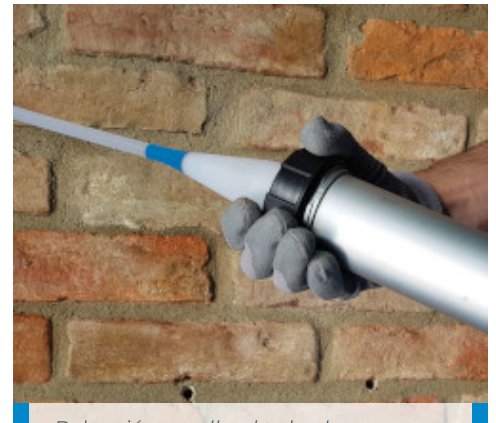
Dokręcić nasadkę do obudowy pistoletu
