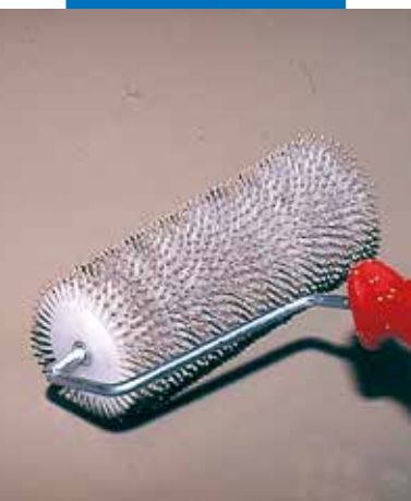
Odpowietrzanie zaprawy za pomocą kolczastego wałka (tzw. jeża)
