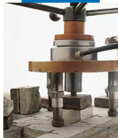
Badanie przyczepności metodą SATTEC
