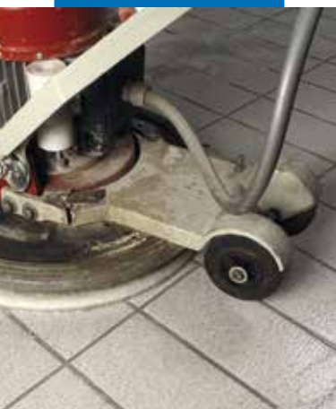
Czyszczenie na mokro przy użyciu maszyny do mycia podłóg z obrotową tarczą typu Scotch-Brite®
